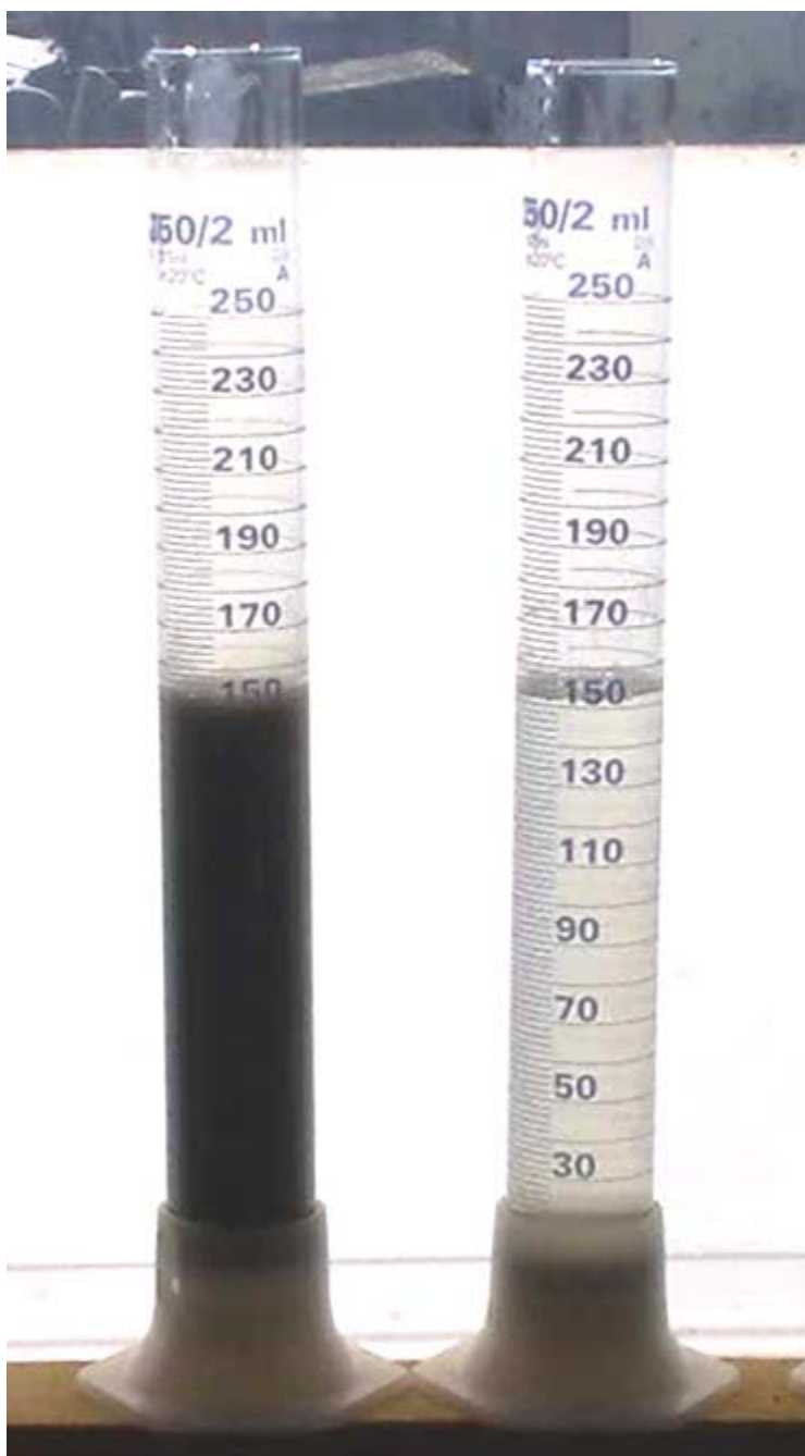
Фиг. 1. Водна суспензия на обработен (ляво) и необработен (дясно) нанодиамантен прах 1 час след обработка с ултразвук. Обработеният прах не показва забележима седиментация в течение на повече от два месеца.
