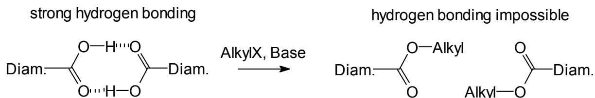
Фиг. 1. Водородни връзки между съседни нанодиамантени частици преди (ляво). След обработката (дясно) образуването на водородни връзки е невъзможно.
